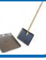
Лопата-движок для снега трёхбортная с накладкой. Изготовлена из дюралюминия толщиной 1,5 мм.
